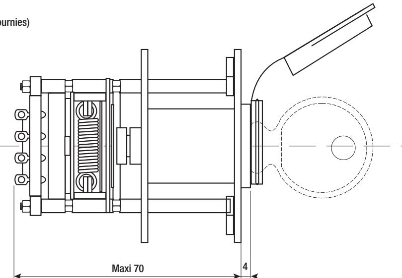
Le Mini A12 SK est un commutateur rotatif à commande par clé. La fixation est assurée par deux vis (non fournies). Ecart angulaire entre 2 positions : 30°, 60° ou 90°.
